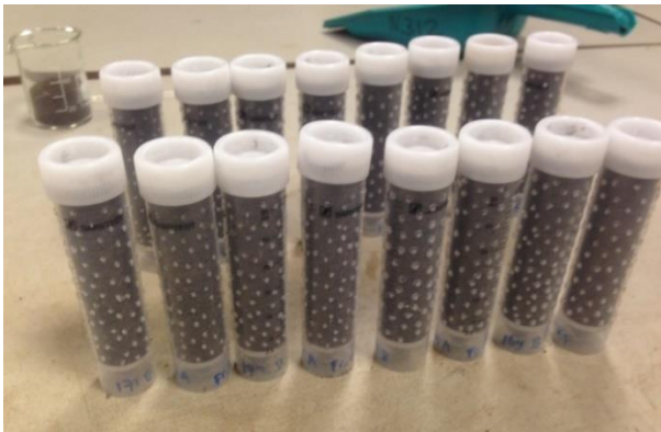
Foto 2: Veenkolommen in geperforeerde 30mL buisjes voor optimale gasuitwisseling
