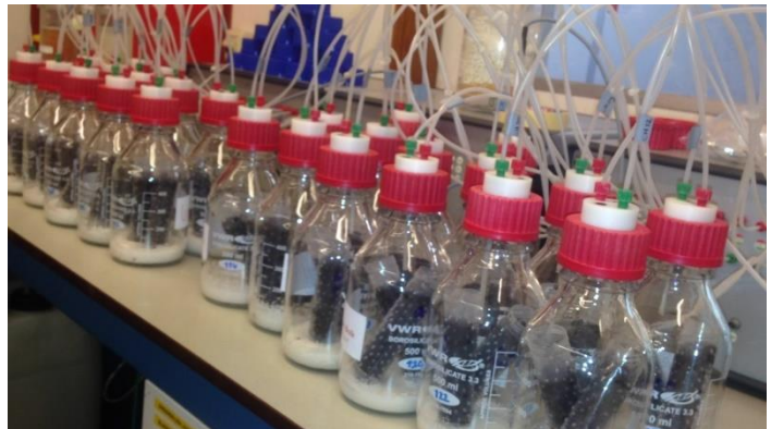
Foto 3: Veenkolommen in incubatieflessen aangesloten aan de respirometer voor periodieke CO 2 metingen
